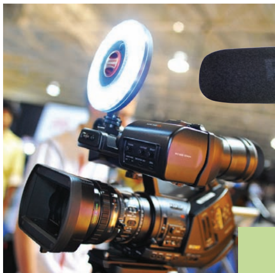
RL48-B, установленный на «башмаке» видеокамеры
